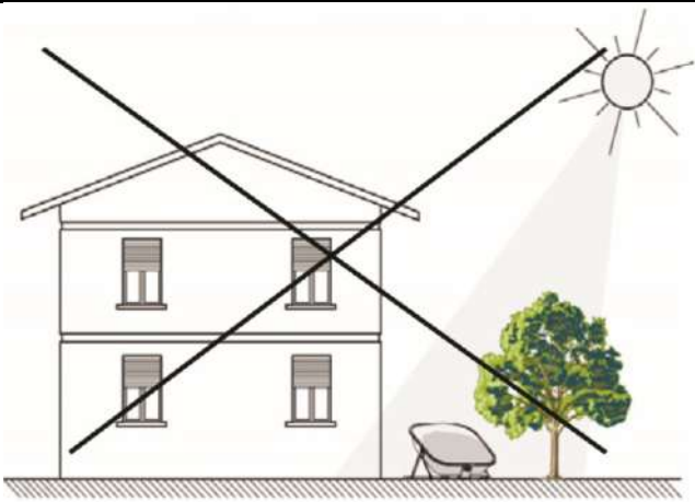
Fig. 2.4-12 Accumulateur solaire positionné partiellement à l'ombre
