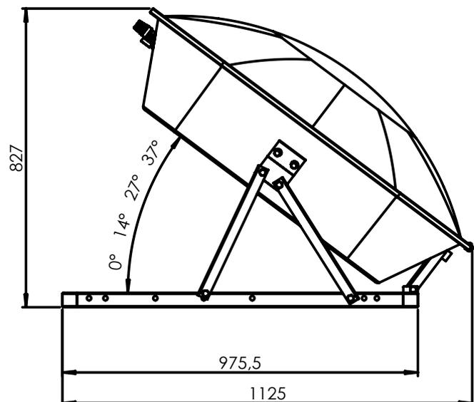
Totem solare per la produzione di acqua calda sanitaria 120L
