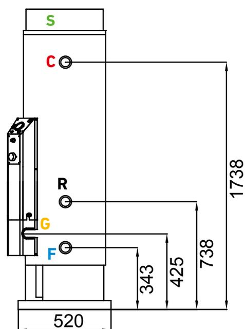
Generatore di acqua calda sanitaria ad accumulo,
