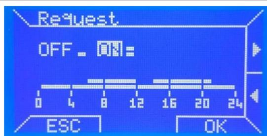
Si seleziona poi se si vuole attivare la richiesta di calore con "ON" oppure no con "OFF" spostandosi sul display con i tasti [▶] e [◀] per selezionare e toccando [OK] per confermare oppure [ESC] per modificare l'orario d'inizio fascia.
