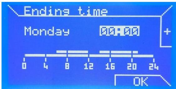
En el último paso se selecciona la hora de fin de banda y se confirma con [OK]. Esta hora no puede ser inferior a la hora de inicio del rango; si selecciona dos valores coincidentes para el comienzo y el final del rango, el programa diario no se modifica. El segundo elemento del menú "Programación" permite copiar el programa de un día a otro, seleccionando el día de origen en la parte superior y el de destino en la parte inferior.
