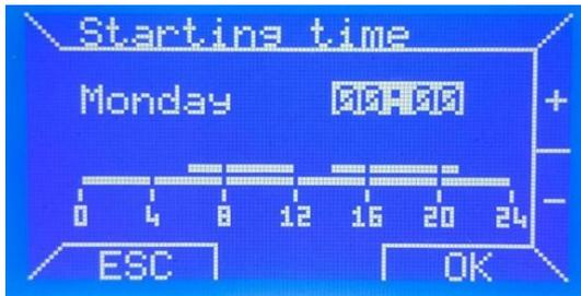
En la primera fase se introduce la hora de inicio, con las teclas [+] y[-], a intervalos mínimos de 15 minutos y se confirma con [OK]. Si desea abandonar la programación del día seleccionado y cambiar el día, simplemente pulse [ESC].
